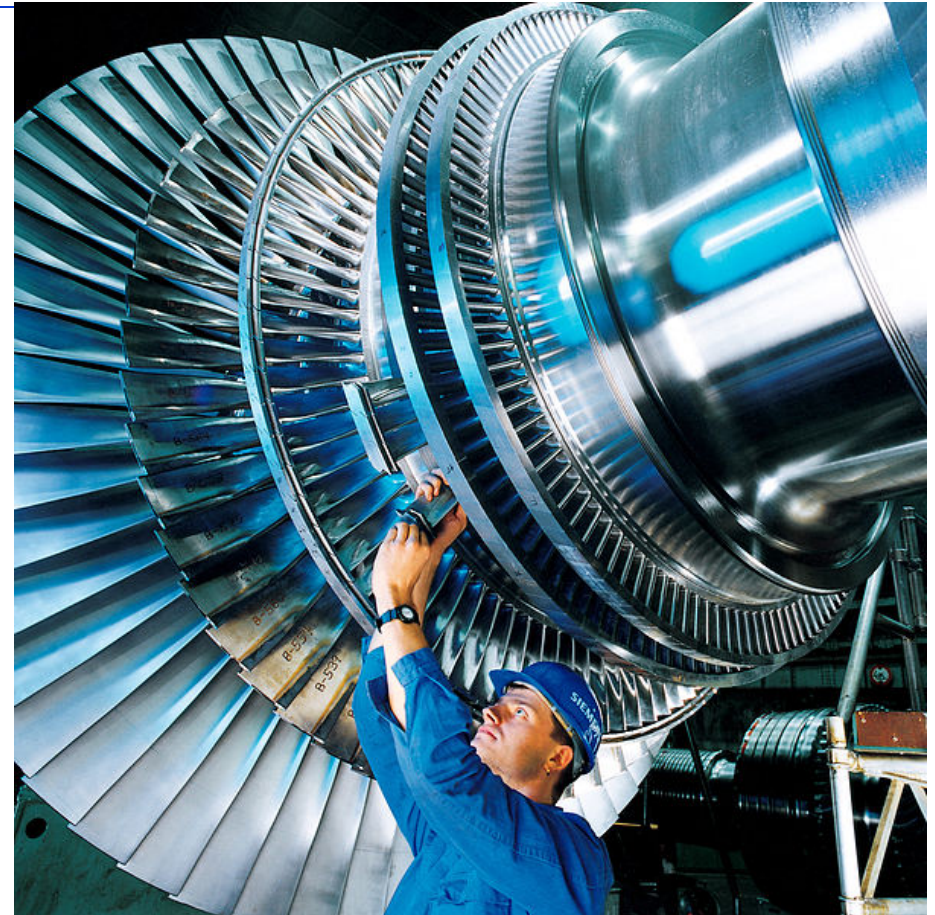
Höryturbiinin roottorin siivekkeet huollettavana
