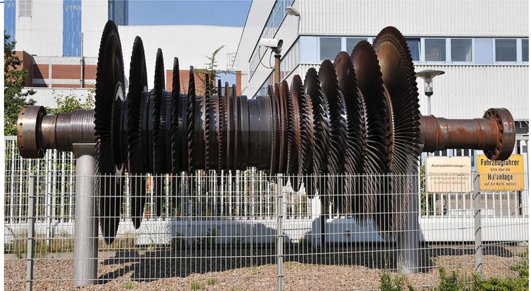
Un rotor de turbine à deux flux. La vapeur pénètre dans le milieu de l'arbre, et ressort aux deux extrémités, équilibrant ainsi la force axiale dans la turbine.
