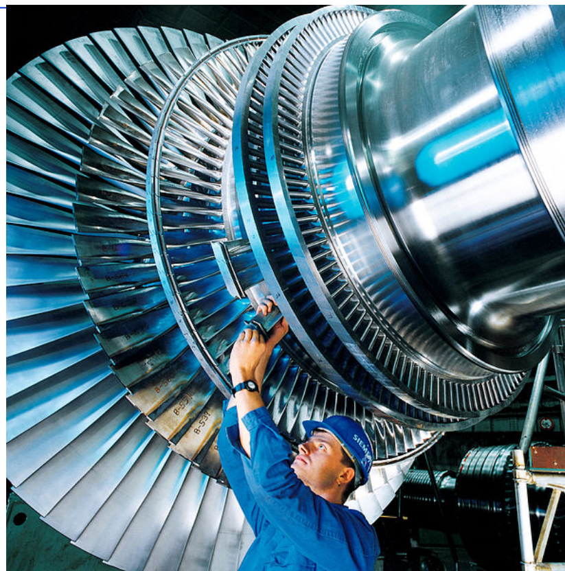
Ostrza wirnika turbiny parowej podczas konserwacji
