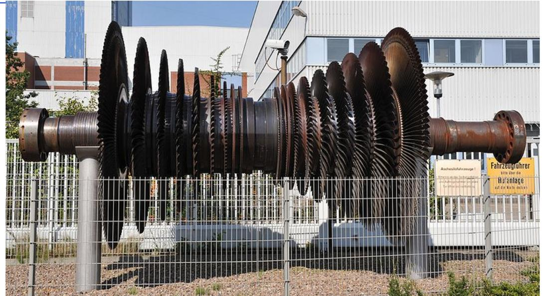
Un rotore a due turbine: il vapore entra nell'asse del rotore bilanciando in tal modo la forza assiale della turbina
