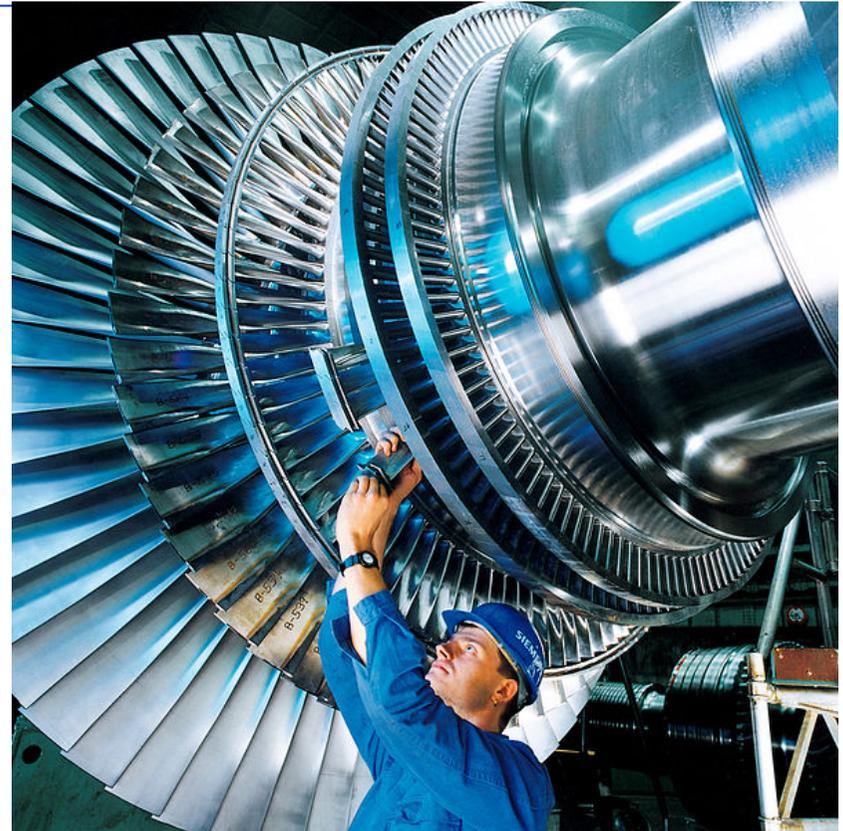
Lame di un rotore di una turbina a vapore in manutenzione
